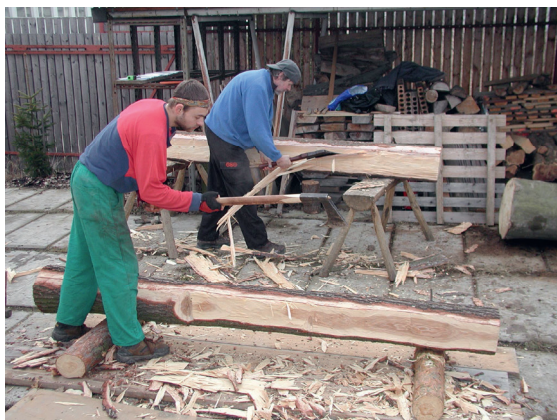
Obr. 23: Suchdol (ČR) – Dva základné spôsoby tradičnej tesárskej práce pri opracovaní kmeňa na trám (vpredu tzv. nízka práca a vzaďu tzv. vysoká práca). Foto: M. Panáček, 2000.
